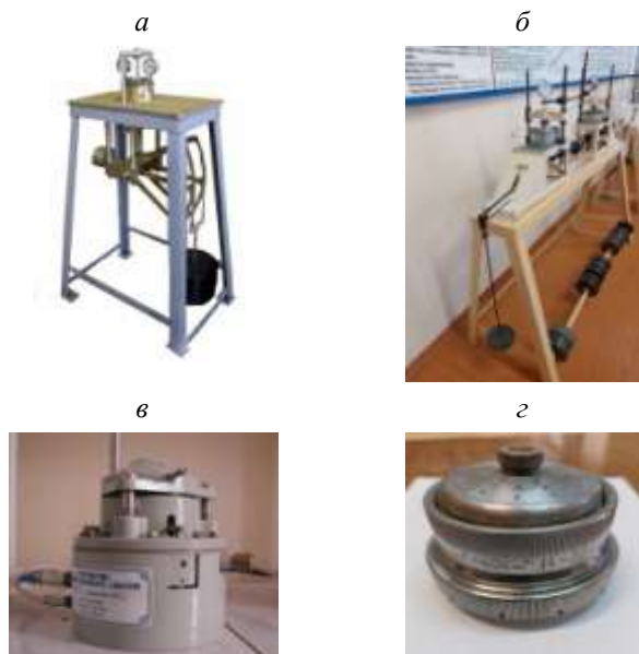
Рис. 1.1. Компрессионные приборы КПр-1 (а), КП-1 (б), автоматизированный (в) и одометр (г)
