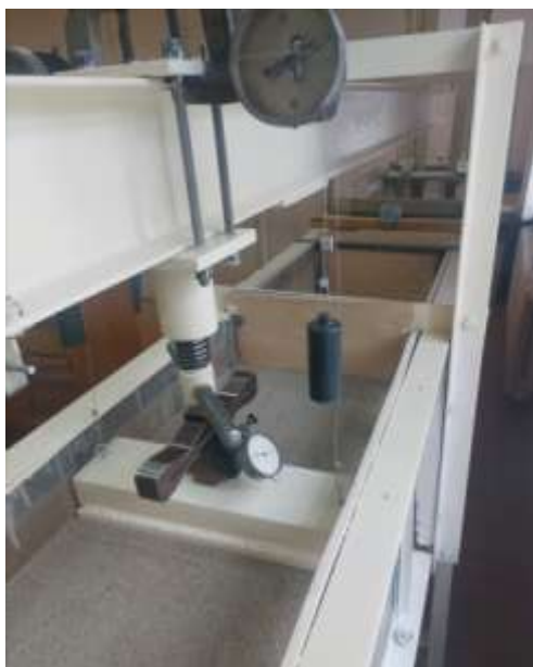
Рис. 3.3. Установка для штамповых испытаний в грунтовой лотке кафедры ИГОФ
