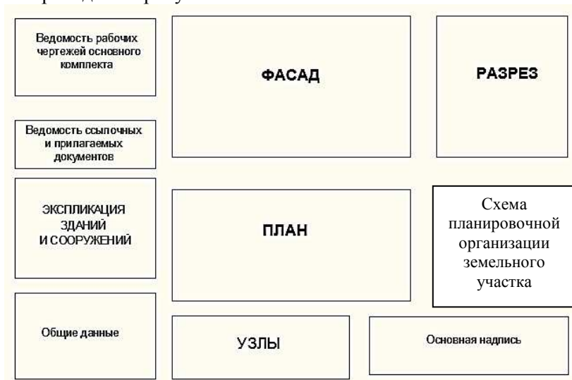
Рисунок 2.7 – Пример компоновки листа архитектурно-строительной части ВКР
