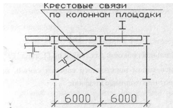
Рис 18. К расчету крестовых связей. Расчетная длина в плоскости связей равна расстоянию от центра узла до точки пересечения элементов, а из плоскости - полной длине элементов
