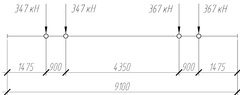
Рис. 17. Схема ходовой части крана
